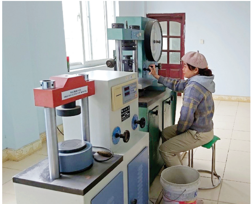
Máy nén mẫu xi măng thuộc Tổ cơ lý, phòng ĐKTT & KCS - Công ty Cổ phần Xi măng Điện Biên.
